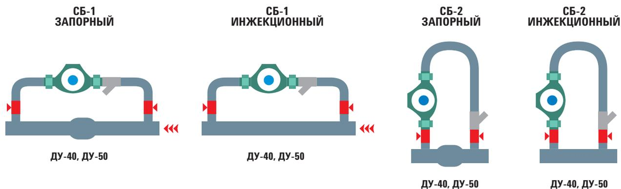
Байпас — это обходной трубопровод, который располагается параллельно основной магистрали. Его наличие также позволяет регулировать или при необходимости отключать определенный участок магистрали без прекращения ее работы.
