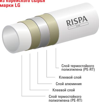
**Основное применение** — отопление, водяной теплый пол, теплые стены и обогрев открытых помещений, горячее и холодное водоснабжение.
